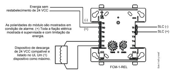
Figura 4.12 NPFA Fiação elétrica estilo Y (classe B) do FCM-1-REL
