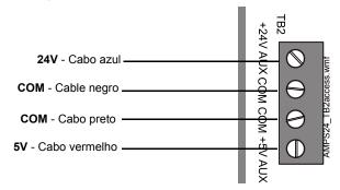
Figura 3.7 Conexão à saída de acessórios do TB2 em CPS-24/E
