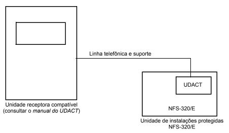
Figura 4.3 Conexões da fiação elétrica típica dos sistemas proprietários do alarme contra incêndios
