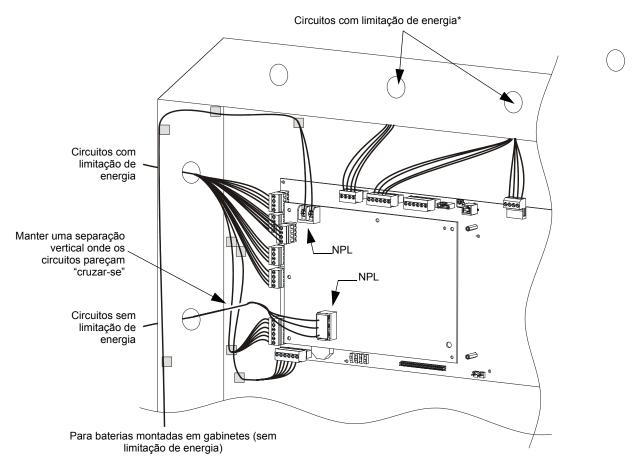
Figura 3.12 Requisitos tópicos do UL para a fiação elétrica com limitação de energia (é mostrado com relés conectados aos módulos com limitação de energia)
