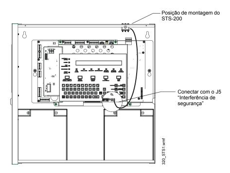
Figura 4.4 Instalação do interruptor de interferência de segurança STS-200
