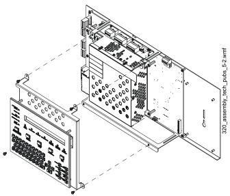
Figura 3.2 Remover e voltar a instalar o KDM-R2
