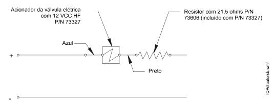
Figura 4.9 Circuitos de descarga (opção 3)
