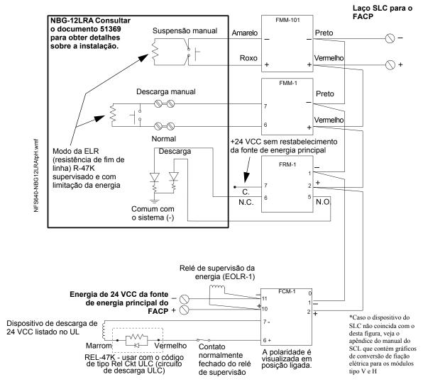
Figura 4.14 Conexões típicas de uma estação de suspensão/descarga de agente NBG-12LRA
