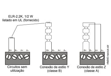
Figura 3.8 Conexões de Circuitos de aparelhos de informação (NAC)
