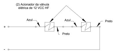
Figura 4.8 Circuitos de descarga (opção 2)
