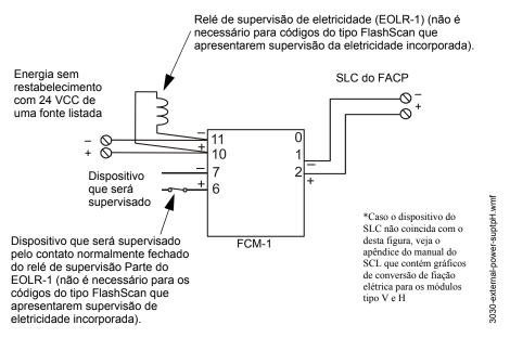
Figura 4.1 Ativação de supervisão da energia externa com uso dos relés
