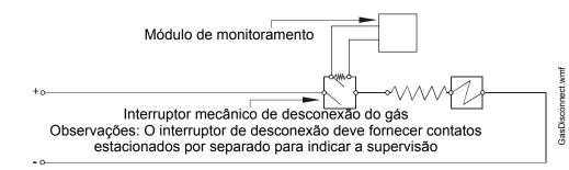
Figura 4.10 Circuitos de descarga (interruptor mecânico de desconexão do gás)
