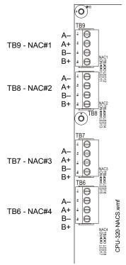
Figura 3.9 Terminais NAC e luzes LED de NAC
