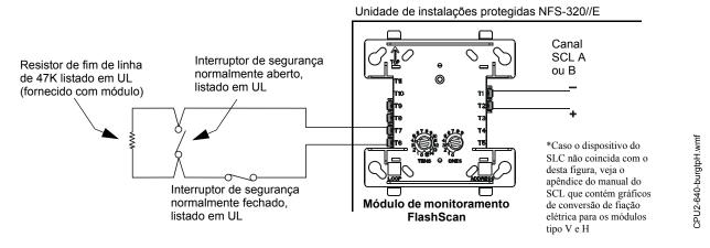
Figura 4.5 Diagrama da fiação elétrica para aplicações proprietárias do alarme de segurança
