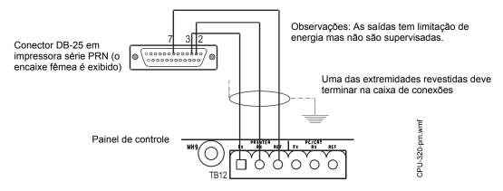
Figura 3.14 Conexões de impressora remota
