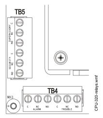
Figura 3.10 Conexões de relé de formato C
