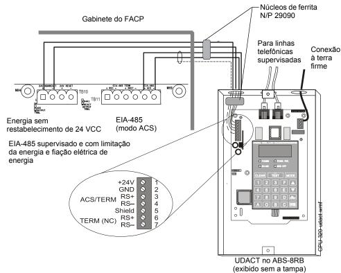
Figura 4.2 Diagrama da fiação elétrica típica de um sistema de alarme contra incêndios da estação central
